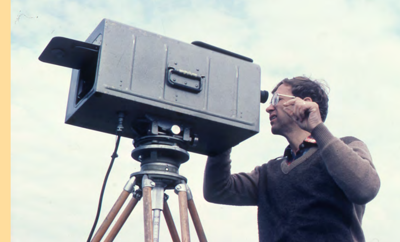
Foto: Kartverket - Avstandsmåling med lasergradlinjeter
